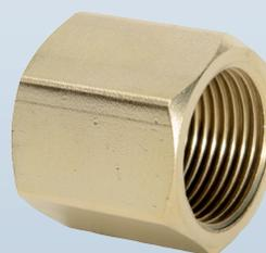
Cilindro roscado internamente y con sección hexagonal en el exterior para tener planos de apriete. Permite conectar 2 piezas rosca macho, iguales o desiguales. La estanqueidad se consigue por la adición de materia ya sea hilo de PTFE o cáñamo.
