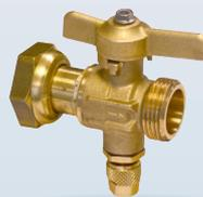
Consente la sostituzione di un contatore DN15, lunghezza 170 mm da un contatore DN15, lunghezza 110 mm senza modificare l'installazione, aggiungendo questo rubinetto da 58 mm (+2mm di guarnizioni)
