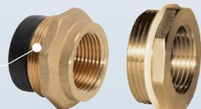
Elemento di trasformazione del raccordo a serraggio esterno Rexuo in raccordo filettato femmina a passo GAS. La tenuta dell'elemento SR7 con il raccordo è assicurata, senza materiale di apporto, grazie all'impiego della guarnizione a corredo REXUO DE20 a 63 mm, uscita filettata 1/2" a 2"
