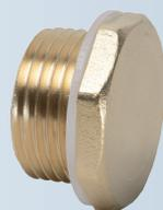
Tappo che permette la messa in attesa o di bloccare una derivazione di utenza. La tenuta si ottiene utilizzando la guarnizione a corredo - Filettatura 1/4" a 2"
